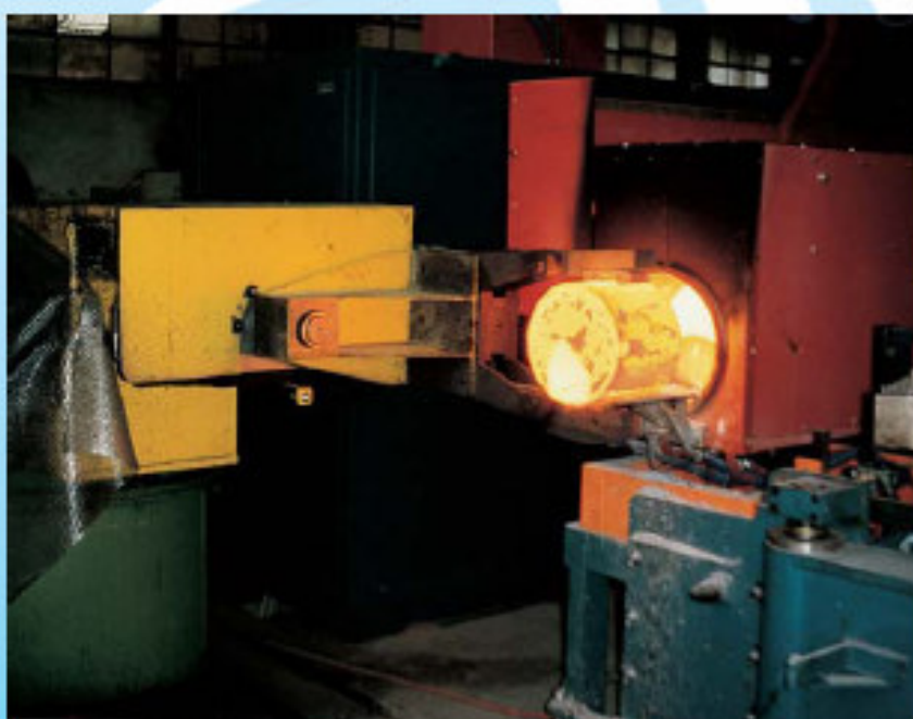
Нагрев для прессовки труб Heating for pipe extrusion
