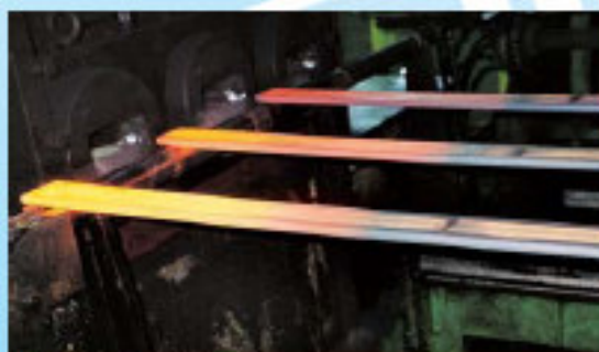
Частичный нагрев плоских пружин для параболического горячего проката Flat springs partial heating for parabolic hot rolling
