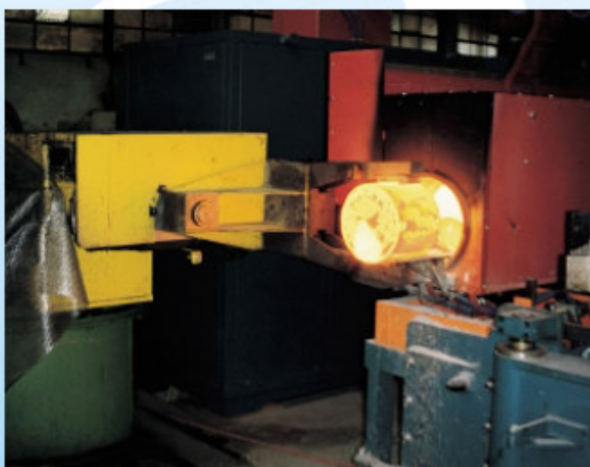
Riscaldamento per estrusione Heating for pipe extrusion
