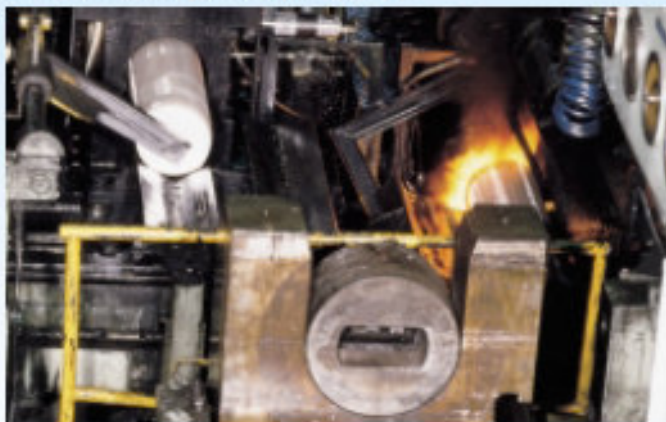
Impianto per riscaldamento conico di alluminio e successiva estrusione
