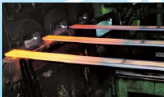
Calentamiento parcial de ballesta para laminación parabólica Aquecimento parcial para laminação em contínuo.
