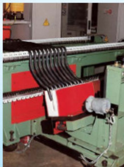
Instalación de calentamiento parcial para barra estabilizadora.
