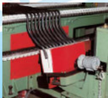
Calentamiento parcial de barra estabilizadora. Aquecimento parcial.
