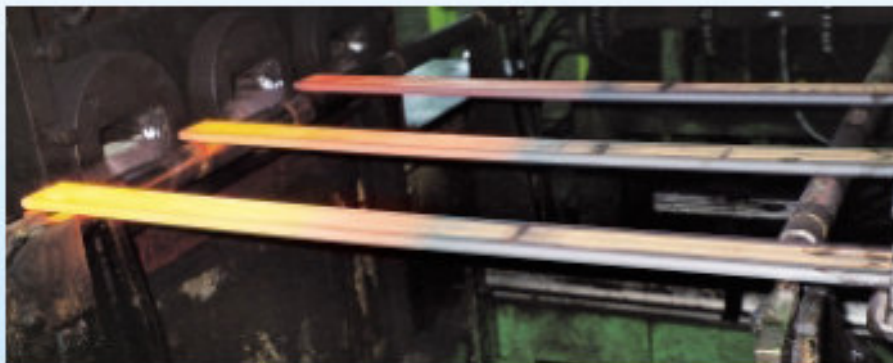
Impianto di riscaldamento parziale balestre per laminazione parabolica Flat springs partial heating plant for parabolic hot rolling
