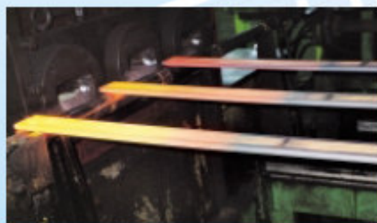
Riscaldamento parziale balestre per laminazione parabolica Fiat springs partial heating for parabolic hot rolling
