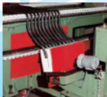
Calentamiento parcial de barra estabilizadora. Aquecimento parcial.
