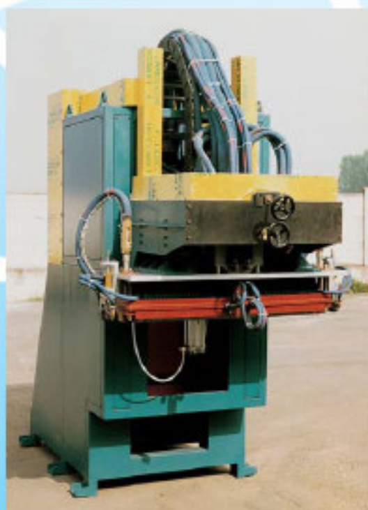
Normalización de la soldadura Normalização do cordão de solda.
