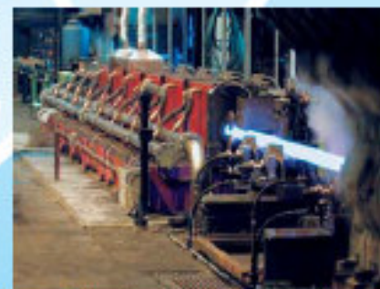
Reducción del diámetro en caliente. Aquecimento para redução de diâmetro.
