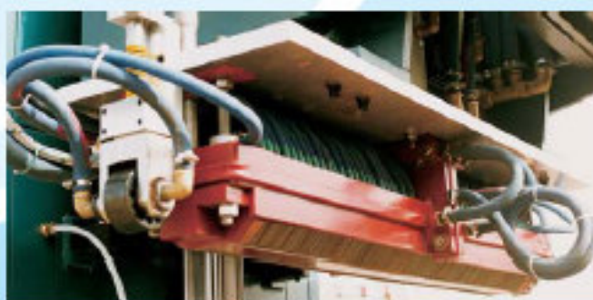
Normalización de la soldadura Normalização do cordão de solda.
