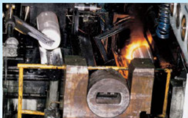
Instalación para calentamiento de tochos de aluminio y para extrusión
