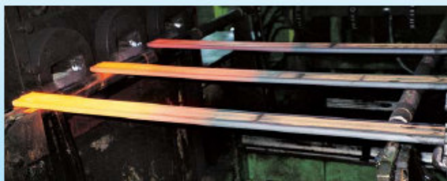
Instalación de calentamiento parcial de llantas. Instalação para aquecimento parcial de aros (rodas)
